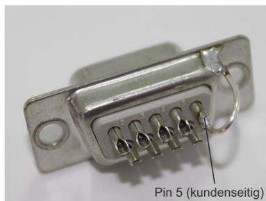
Abb. 7: Buchse Anschlusskabel
