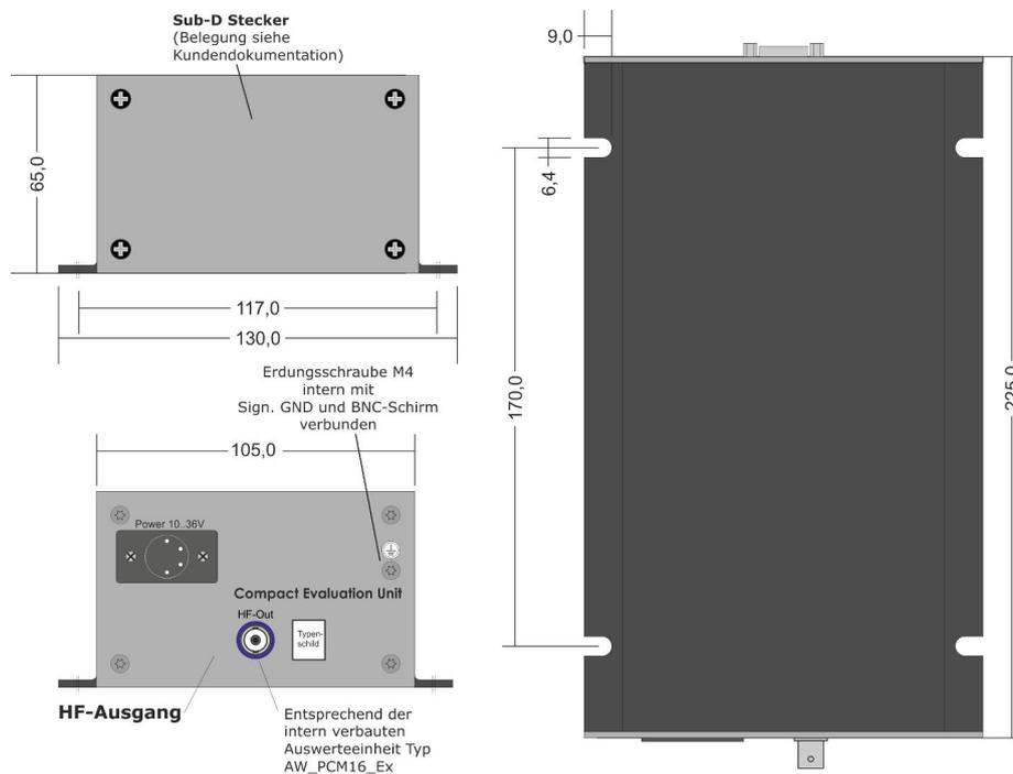
Abb. 15: Auswerteeinheit in Tubus-Gehäuse (Maße und Anschlüsse)
