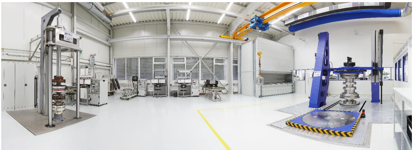
Abbildung 1 Klimatisiertes Kalibrierlabor mit 5 Prüfständen von 50 N·m – 500 kN·m
