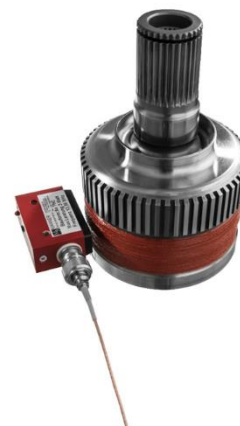
Abbildung 2 Kompensierter Getriebebeflansch mit induktiver Versorgungsantenne (weitere Miniaturisierung der Antenne möglich)
