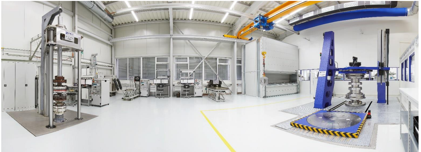
Abbildung 2: MANNER Kalibrierlabor mit 5 Prüfständen von 200Nm bis 500 kNm
