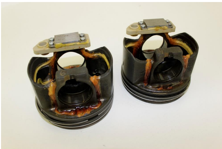
Abbildung 1 Bilder von Kolben nach 80 Stunden Befeuerung im Motor bei 400-500°C - noch vollständig funktionsfähig
