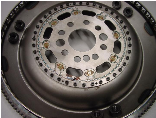
Abbildung 5 Flexplate-Aufnehmer mit 160^{\circ}\text{C} Temperaturfestigkeit zur Erfassung dynamischer Drehmomente
