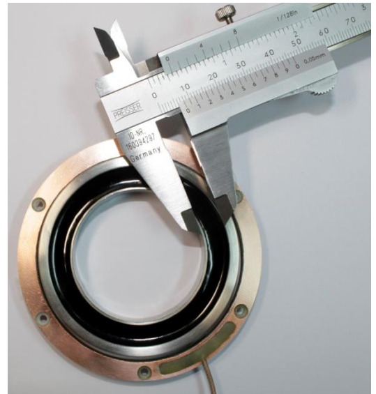
Abbildung 3 6-Kanal Messverstärker im Miniaturgehäuse und dazugehörige Statorantenne
