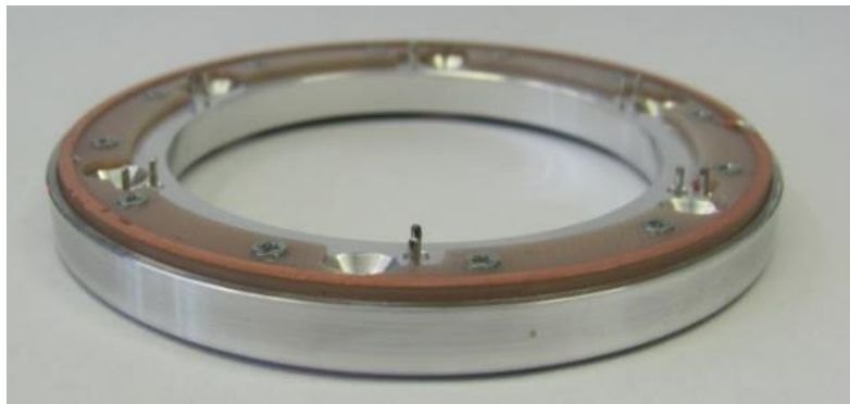
Abbildung 4 6-Kanaliger Rotorring mit Induktionsschleife und Pins für den Thermoelementanschluss
