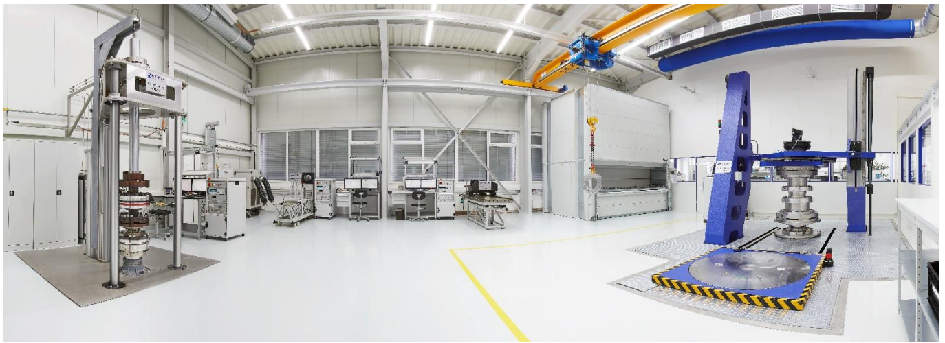
Abbildung 2 Klimatisiertes Kalibrierlabor mit 5 Prüfständen von 50 N·m – 500 kN·m
